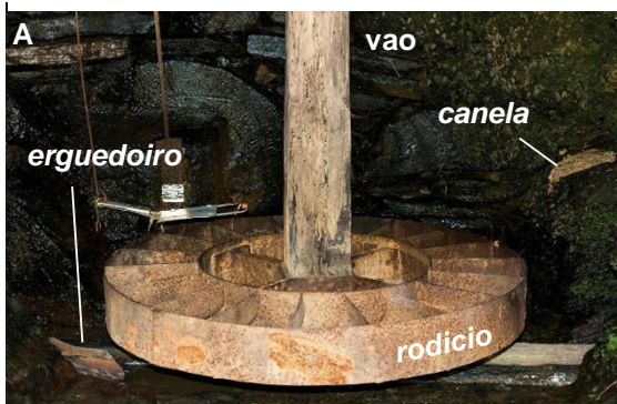
Fig. 12. Partes do dispositivo de funcionamento do muíño de Vieiros.
