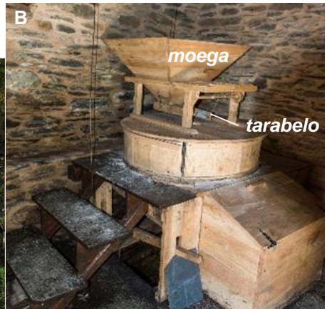
Fig. 12. Partes do dispositivo de funcionamento do muíño de Vieiros.
